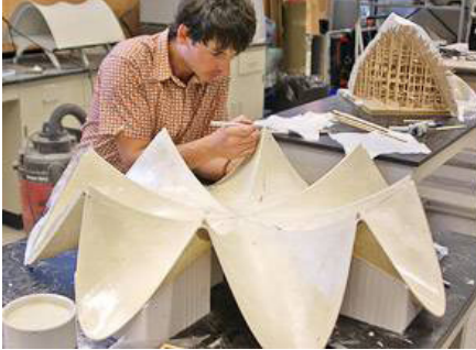
Maquettes des toitures de Felix Candela, Cours donné à Princeton par David P. Billington
